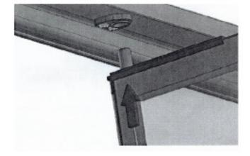
2 - Fixer le profil inférieur en utilisant les perçages prévus à cet effet
