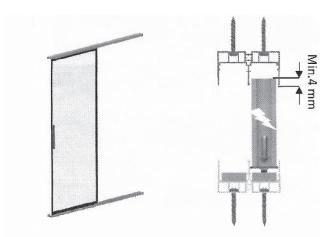
8- Vérifier que la cote minimum en position ouverte reste identique à celle de en position fermée.
