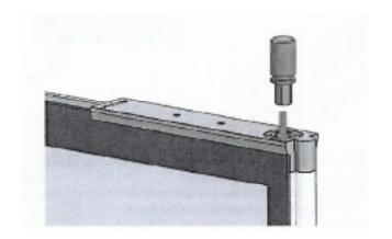
5 - Monter la porte, insérer l'axe supérieur dans l'emplacement cylindrique du profil supérieur
