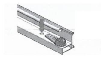
4 - Inserer la goupille métallique de l'axe hélicoidal en plastique dans la partie inférieure de la porte
