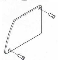
embout pour profil 3049 ref. 07.441.6753.11 dim. 70 x 50 x 2mm alu anodisé argent
