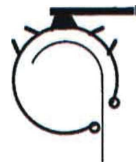
Enroulement de la toile sur l'arrière Fixation plafond (5)
