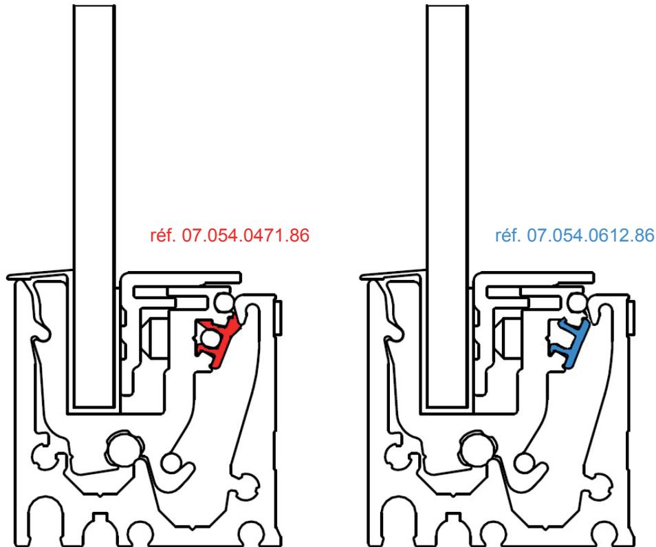
Le nouveau profil autobloquant T130 permet un meilleur blocage de la glace grâce au **joint plastique réf. 07.054.0471.86**.
